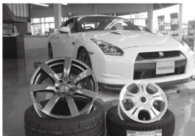
最後に旬な話題であるNISSAN GT-Rの純正装着タイヤについて。GT-Rにはバンクしても所定のスピードで一定の距離を安全に走行することができる20インチサイド補強型RFT(ランフラットタイヤ)が採用されています。通常のタイヤでも交換難易度の高い20インチワイドタイヤにサイド補強されたRFTが採用されたため、一度ホイールから外したタイヤはカーメーカーの意向により再利用できません。普通のクルマで考えると値段も驚きのハイスペックタイヤですが、GT-Rは(マルチパフォーマンス)スーパーカーなのですね。タイヤ館米子は「ブリヂストン推奨RFT取扱店」ですが、GT-Rのタイヤ交換に関してはNHPC(日産ハイパフォーマンスセンター)からの依頼によりブリヂストンが許可した技術者しか作業を行うことができません。ちなみに鳥取県西部地区には2名しか許可されず、その内のひとりとは私です。ちょっと自慢してみました。(笑)
